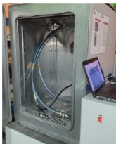
Şekil 1. Eklemlerin basınç çevrimine direnci deneyi sistemi
