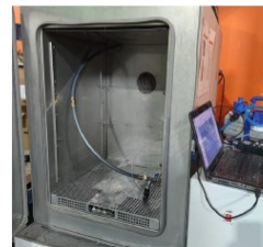
Şekil 1. Vakum altında sızdırmazlık deneyi sistemi
