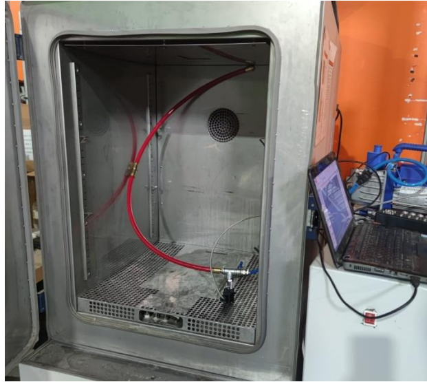
Şekil 1. Vakum altında sızdırmazlık deneyi sistemi
