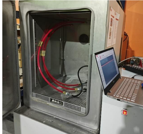
Şekil 1. Eklemlerin basınç çevrimine direnci deneyi sistemi
